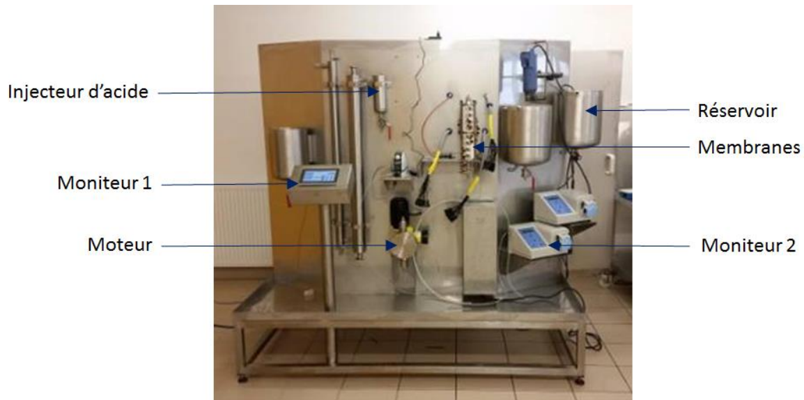
Figure 3 : Photo de la machine à émulsion créée par Génialis (prise lors de la visite de Génialis à Bourges)
