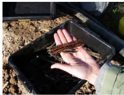
Figure 16 : Contrôle de l'état de pourrissement des rhizomes de Renouée après une année de bâchage [10]
