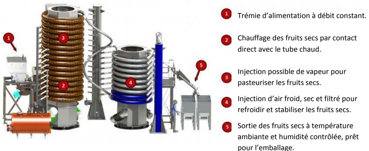
Fig2 : Exemple d'installation de torréfaction des fruits à coques(16)
