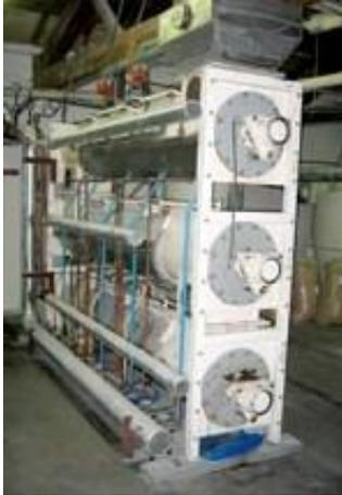
Figure 2 : machine utilisée pour le floconnage <sup>[4]</sup>
