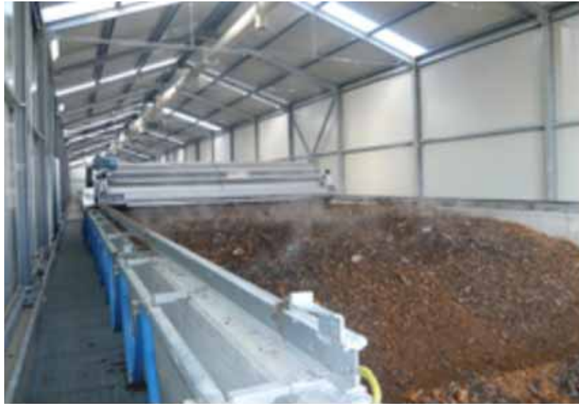
Illustration 2: Installation de séchage sans flux de matière mais avec brassage ([5]), environ 60000€.
