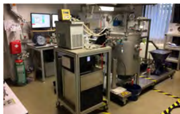
Vue générale du méthaniseur pilote de 100 L et de son instrumentation
