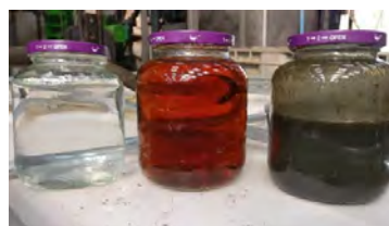
Les 3 fractions obtenues après raffinage du digestat, eau et 2 fertilisants spécifiques
